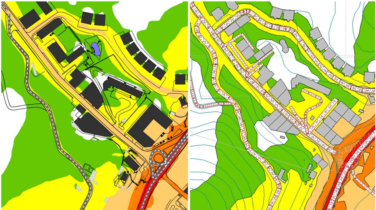
14. irudia. Garapen berriaren inguruko egungo egoeraren Ld arratsaldeko zarata-mailaren laburpena. Ezkerrean. Elgoibarko Zarata Mapan lortutako emaitzak, eskuinean. simulazioan lortutakoak
